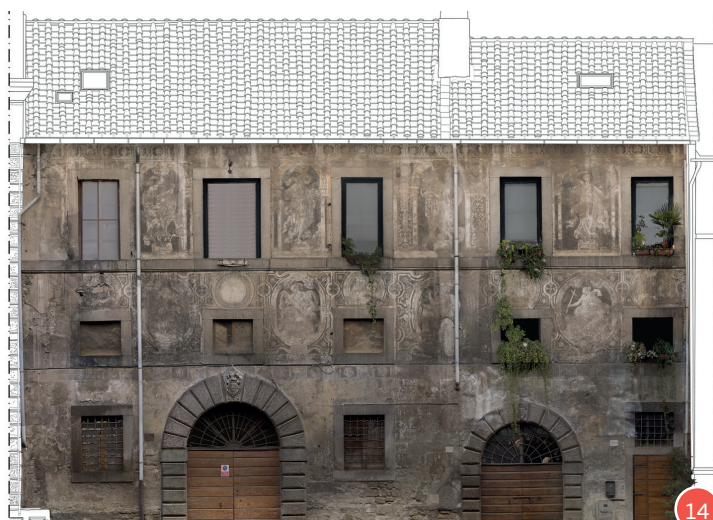
Fig. 14 Prospetto delle ex-scuderie di Palazzo Nini ottenuto tramite il software Photoscan, Viterbo, 2019
